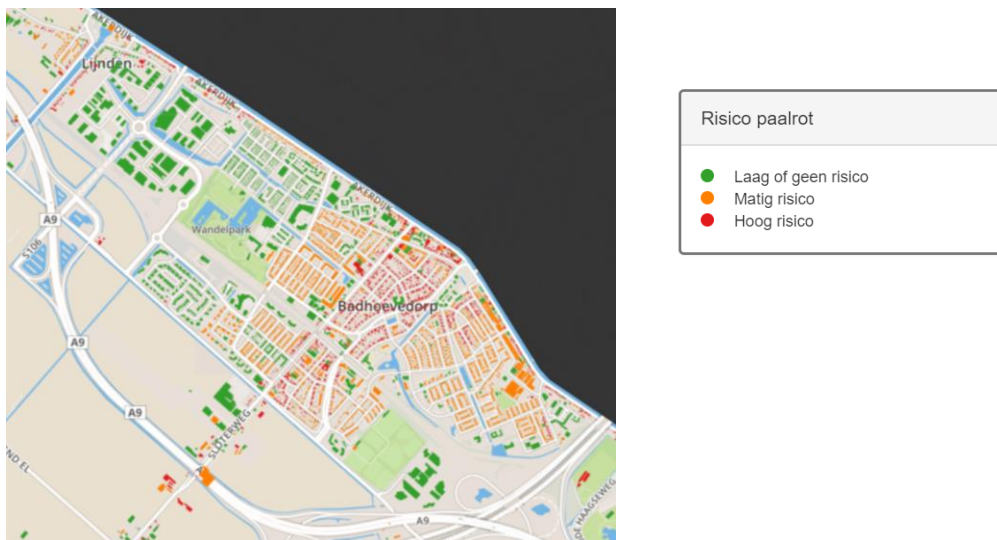
Figuur 7 - Risico van panden op rotting van de funderingspalen bij uitdroging van de bodem. (Lizard, 2016)
